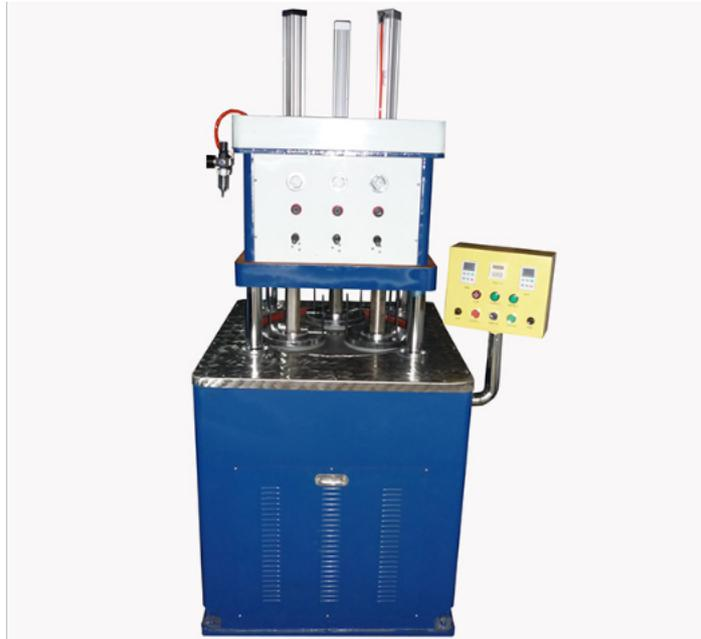
机械密封是靠两个经过精密加工的动环和静环的端面靠弹簧沿轴向紧接触来达到密封的。(静环固定,动环与轴一起旋转)所以又称端面密封。机械密封的结构为单端面非平衡型大弹簧机械密封的典型结构。机械密封在进行批量生产和机械密封维修虽较大的情况下要使用研磨机,研磨机是研磨平面的一种专用设备,按其结构型式分机械研磨机和电磁振动研磨机等。在机械研磨机中有单面研磨机、双面研磨机。一些自动化程度较高的研磨机,还可以自动加压和自动测量工件厚度,研磨效率较高。温州市百诚研磨机械有限公司为您提供 研磨机,欢迎新老客户来电!杭州高精度平面研磨机销售厂
